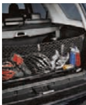
Filet de rétention
